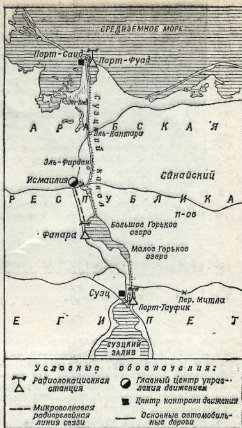
Расположение объектов системы управления движением судов по Суэцкому каналу
